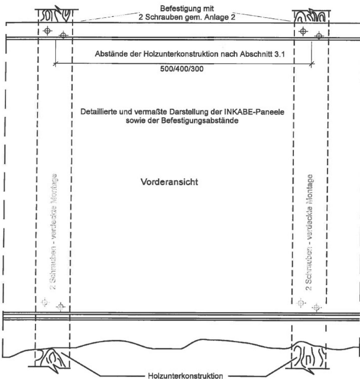
Panele "M 32" aus Polyurethan-Hartschaum mit Aluminium-Deckschichten zur Verwendung als Außenwandbekleidung
