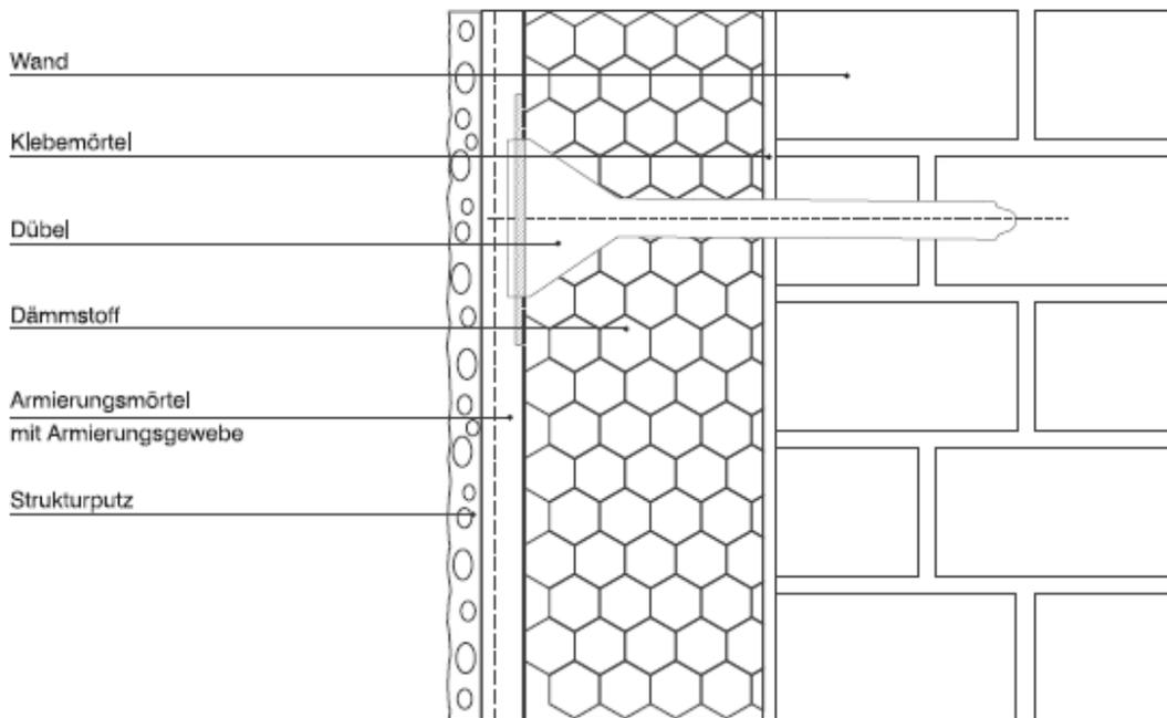
Teilflächige Verklebung der Mineralfaser-Lamellendämmplatten:
