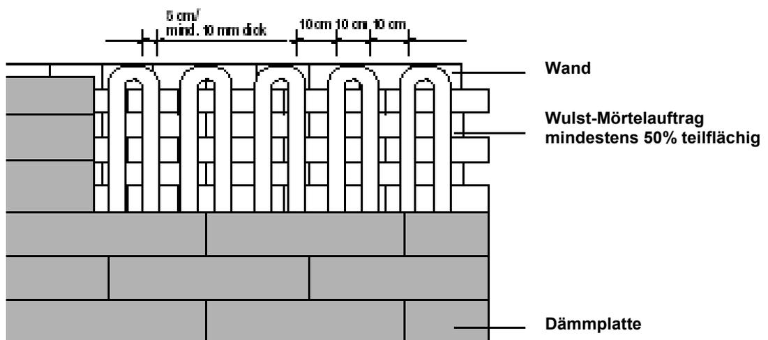
Wärmedämmverbundsysteme mit angedübelten und angeklebten Dämmplatten **Anlage 2.1**
