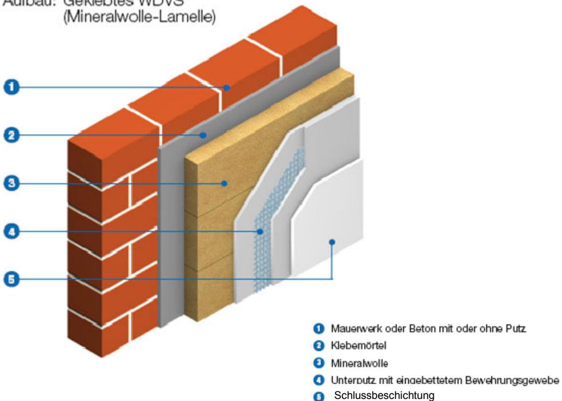
Wärmedämm-Verbundsystem mit angeklebten Mineralfaser-
