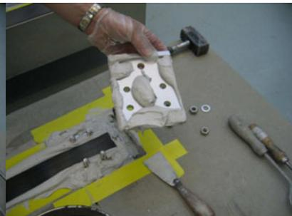
Auf die Deckplatte wird ebenfalls Klebstoff aufgetragen
