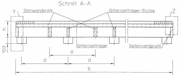
Ausführungsvarianten: stationäre Auffangwannen mit glattem Boden stationäre Auffangwannen mit Füßen
