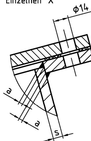
wahlweise : a ) Losdeckel mit Durchgangsschrauben M 12
