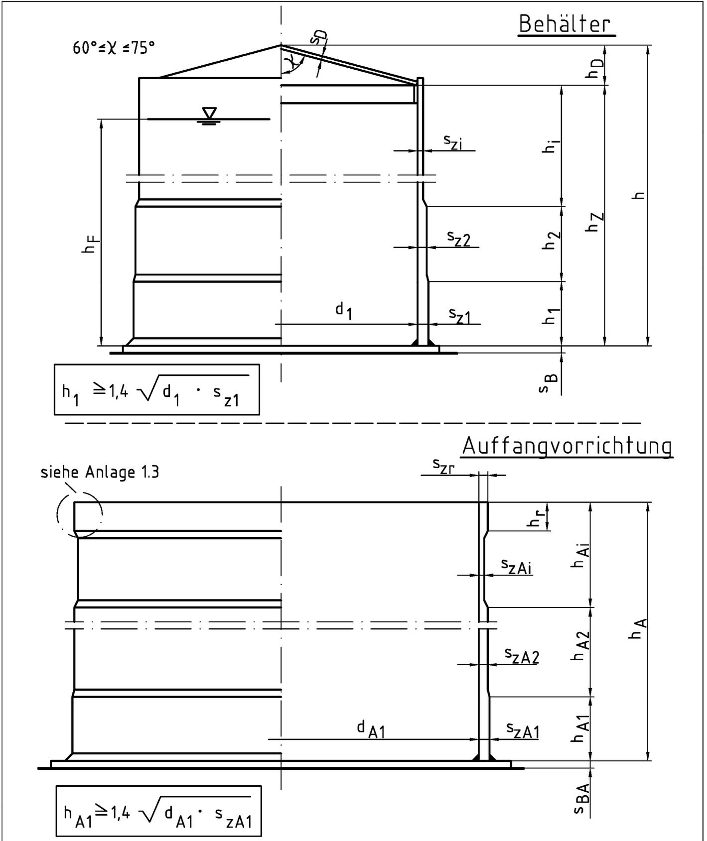
Zylindrische Flachbodenbehälter und Auffangvorrichtungen aus Polyethylen (PE) mit gewickelten Zylindermänteln (Wickelrohrbehälter)
