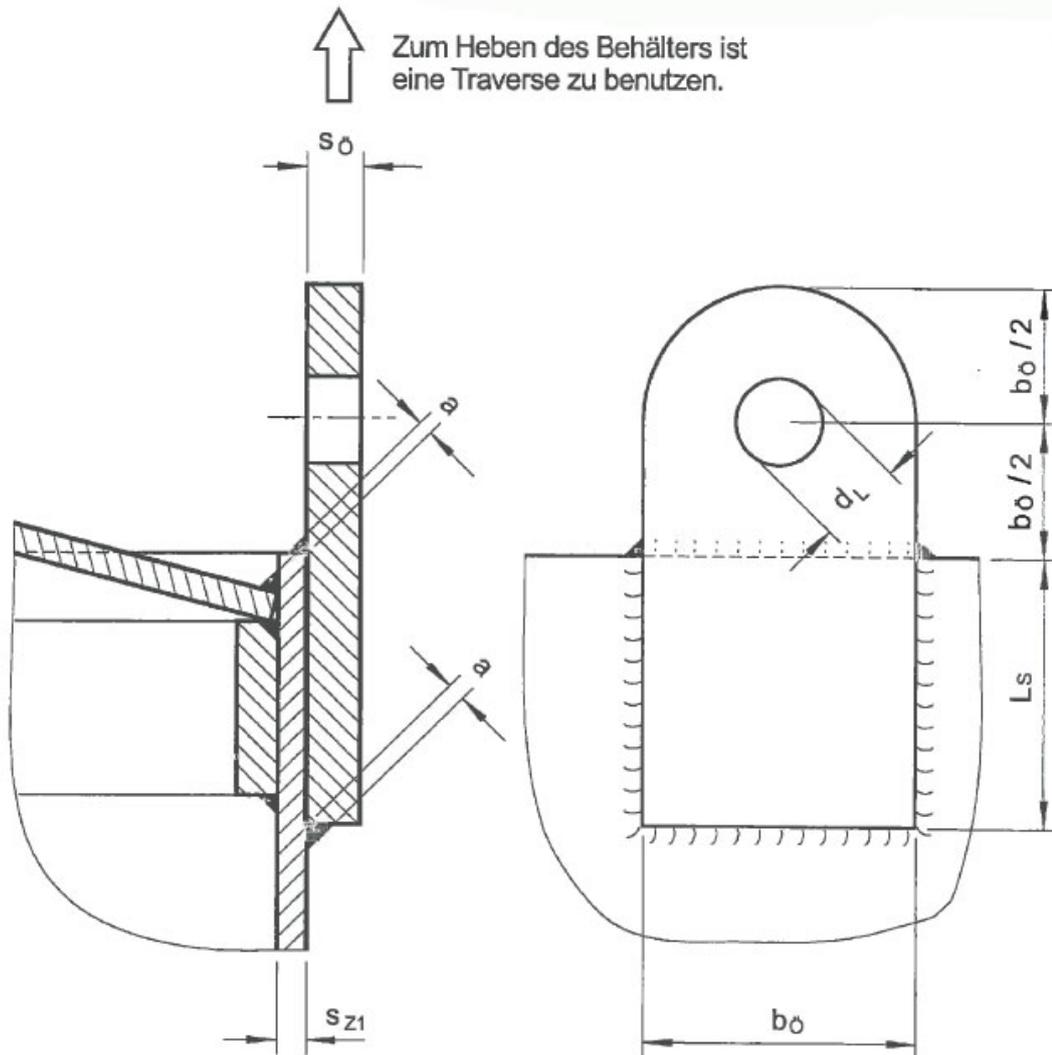
$$a \geq 0,7 \cdot s_{z1} \quad (\text{umlaufend})$$
