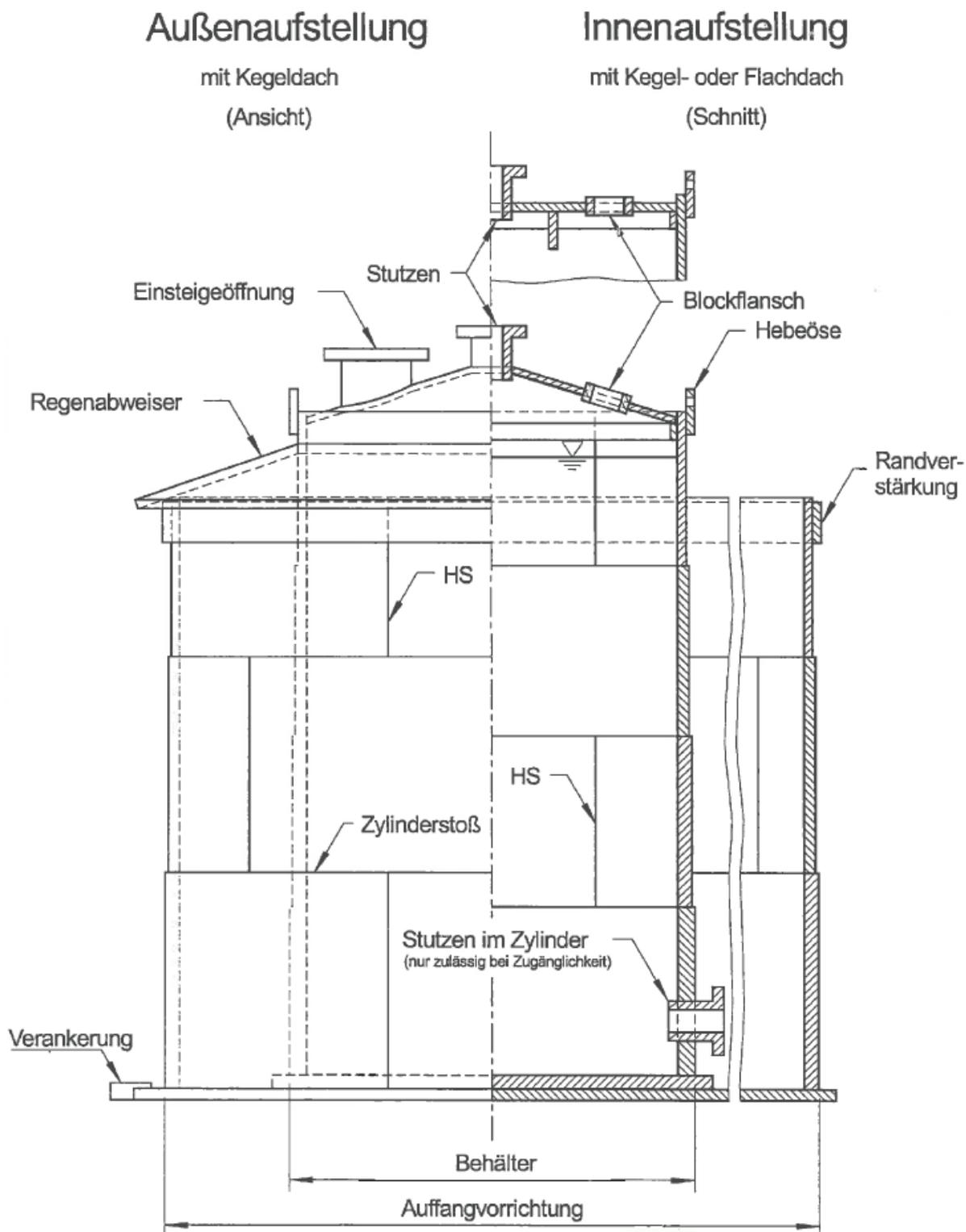
Zylindrische Flachbodenbehälter und Auffangvorrichtungen aus Polyethylen PE-HD mit Zylindermänteln aus verschweißten Tafeln
