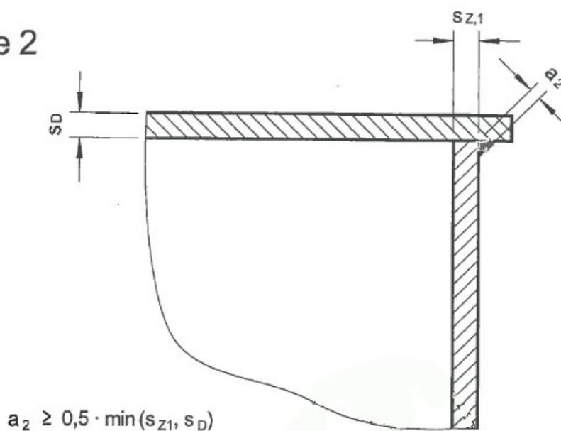
Zylindrische Flachbodenbehälter und Auffangvorrichtungen aus Polyethylen PE-HD
