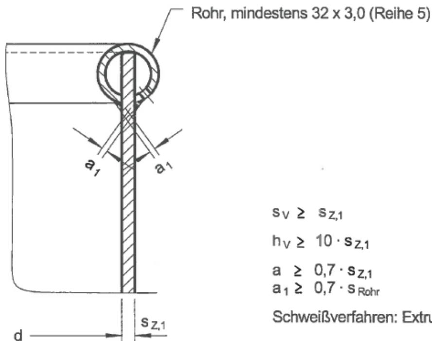
Zylindrische Flachbodenbehälter und Auffangvorrichtungen aus Polyethylen PE-HD
