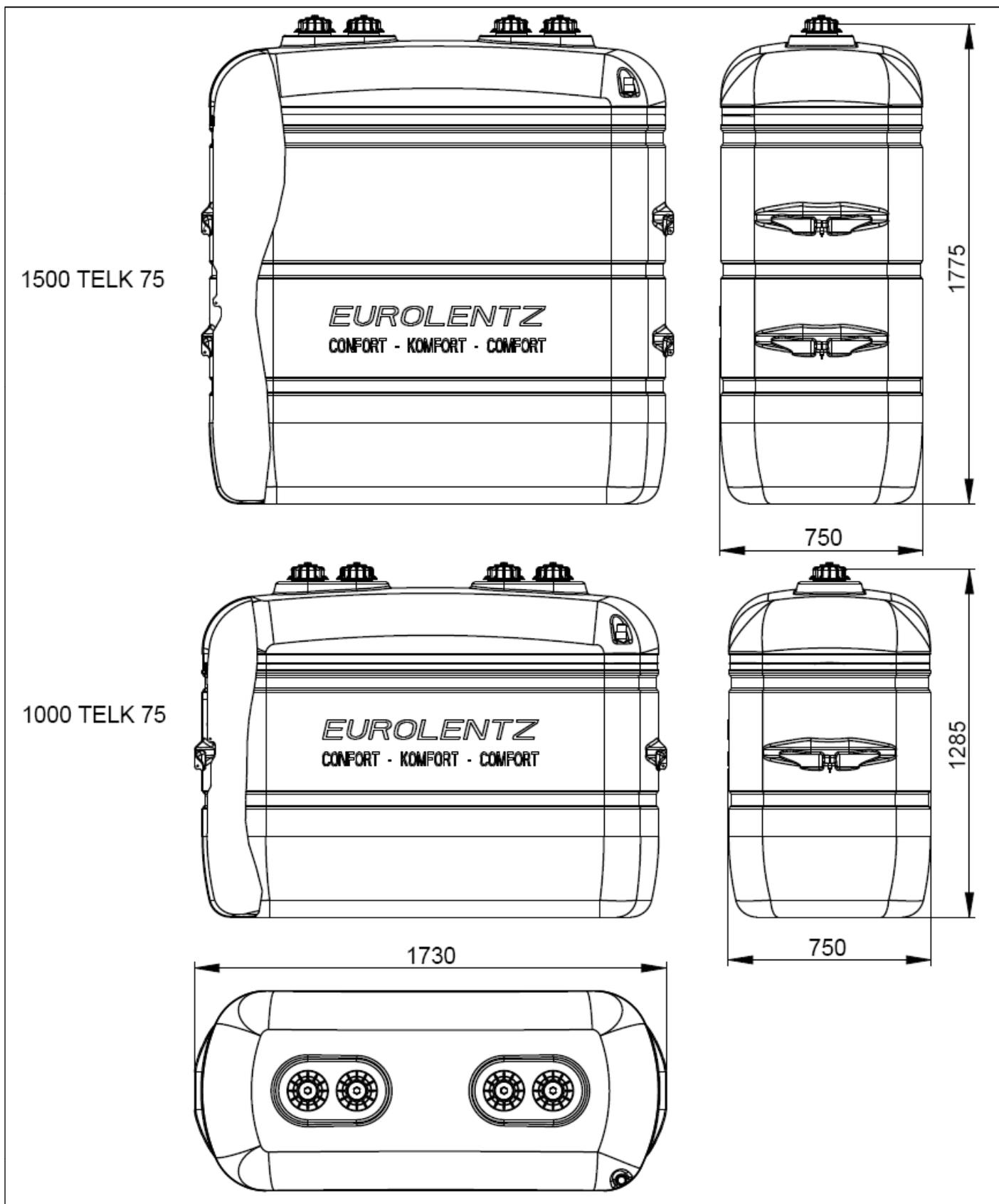
Blasgeformte Behälter mit integrierter Auffangvorrichtung aus Polyethylen (PE-HD)
