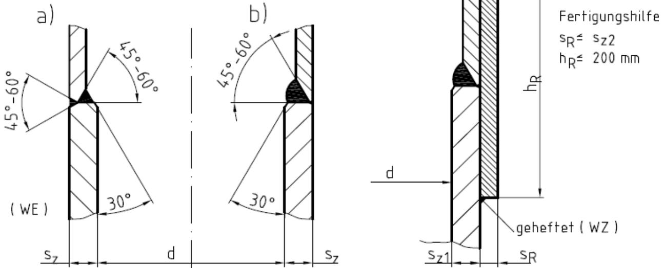
Verbindung Zylinder mit Boden
