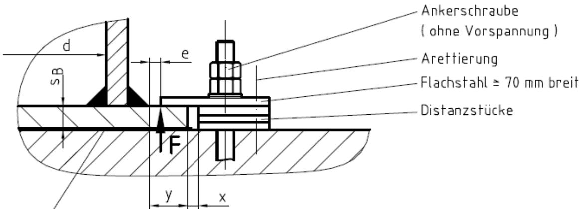
PE - Zwischenplatte  $\geq 2$  mm
