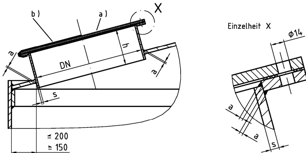
wahlweise : a ) Losdeckel mit Durchgangsschrauben M 12
