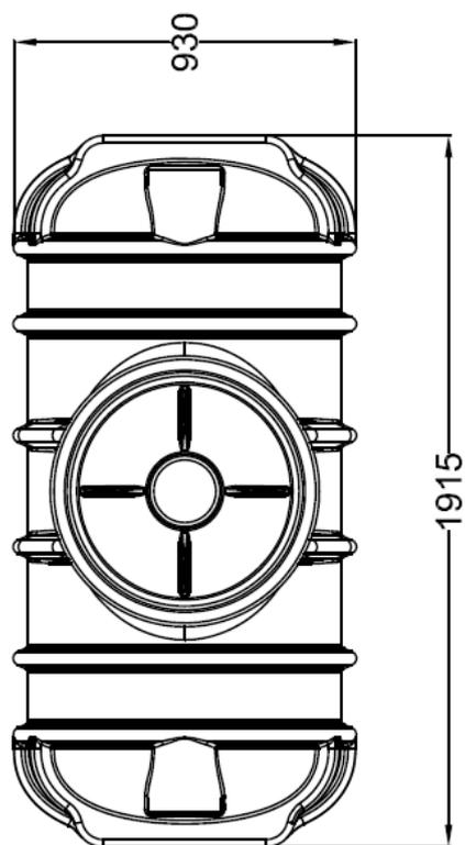
Abflusslose Sammelgrube aus Polyethylen (PE-LMD)
