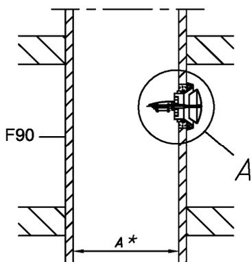
Einbau in Schachtwand mit Anschluss an luftführende Lüftungsleitung
