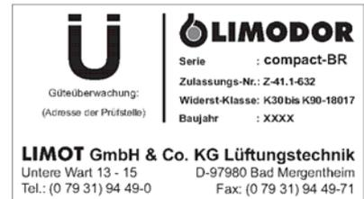
(Aufkleber an der Innenseite des Gehäusekastens)
