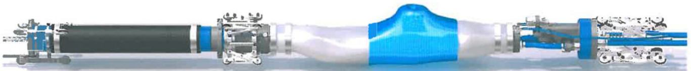
B. Luftleerer Packer nach dem Einführen, vor der Positionierung, Korb oben
