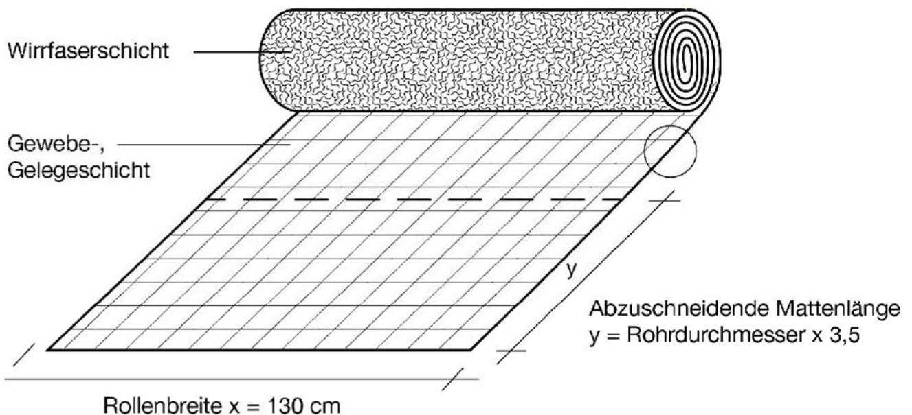
Kurzlinungsverfahren mit der Bezeichnung WILLKAT® PL „Short Liner System“ zur Sanierung erdverlegter schadhafter Abwasserleitungen im Nennweitenbereich DN 100 bis DN 500
