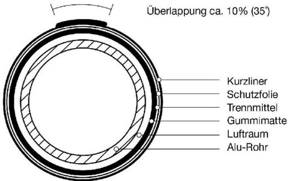
Kurzlinungsverfahren mit der Bezeichnung WILLKAT® PL „Short Liner System“ zur Sanierung erdverlegter schadhafter Abwasserleitungen im Nennweitenbereich DN 100 bis DN 500
