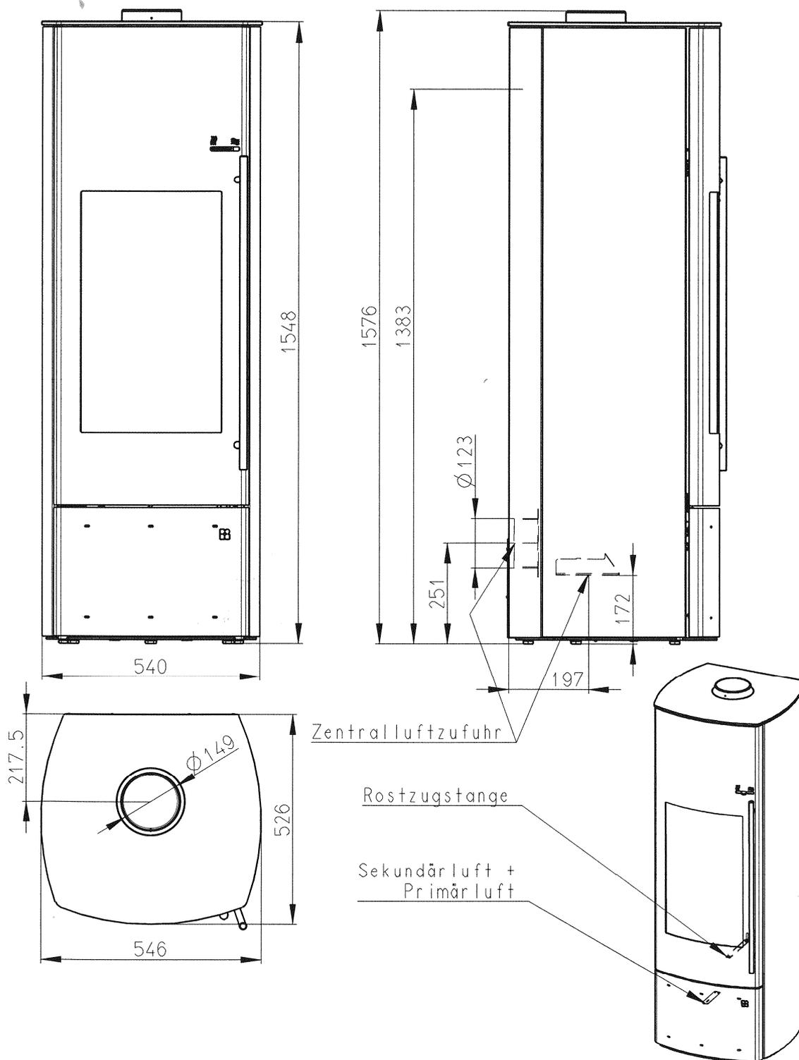
Raumluftunabhängige Feuerstätte mit Wassererwärmung mit der Bezeichnung
