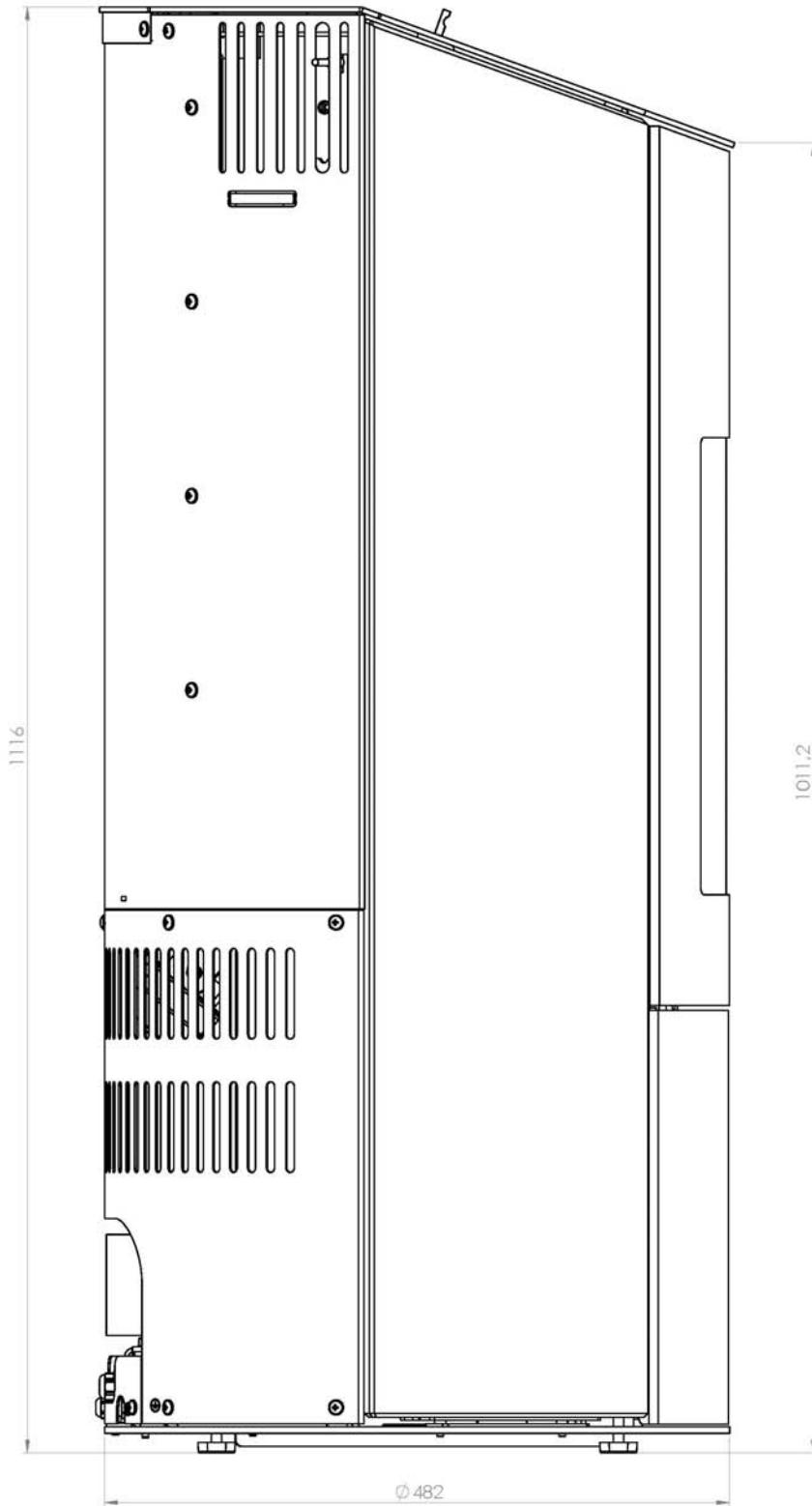
Raumlufturnabhängiger und schnellregelbarer Raumheizer mit der Bezeichnung "Levana" und einer Nennwärmleistungen von 6 kW zur Verfeuerung von Holzpellets
