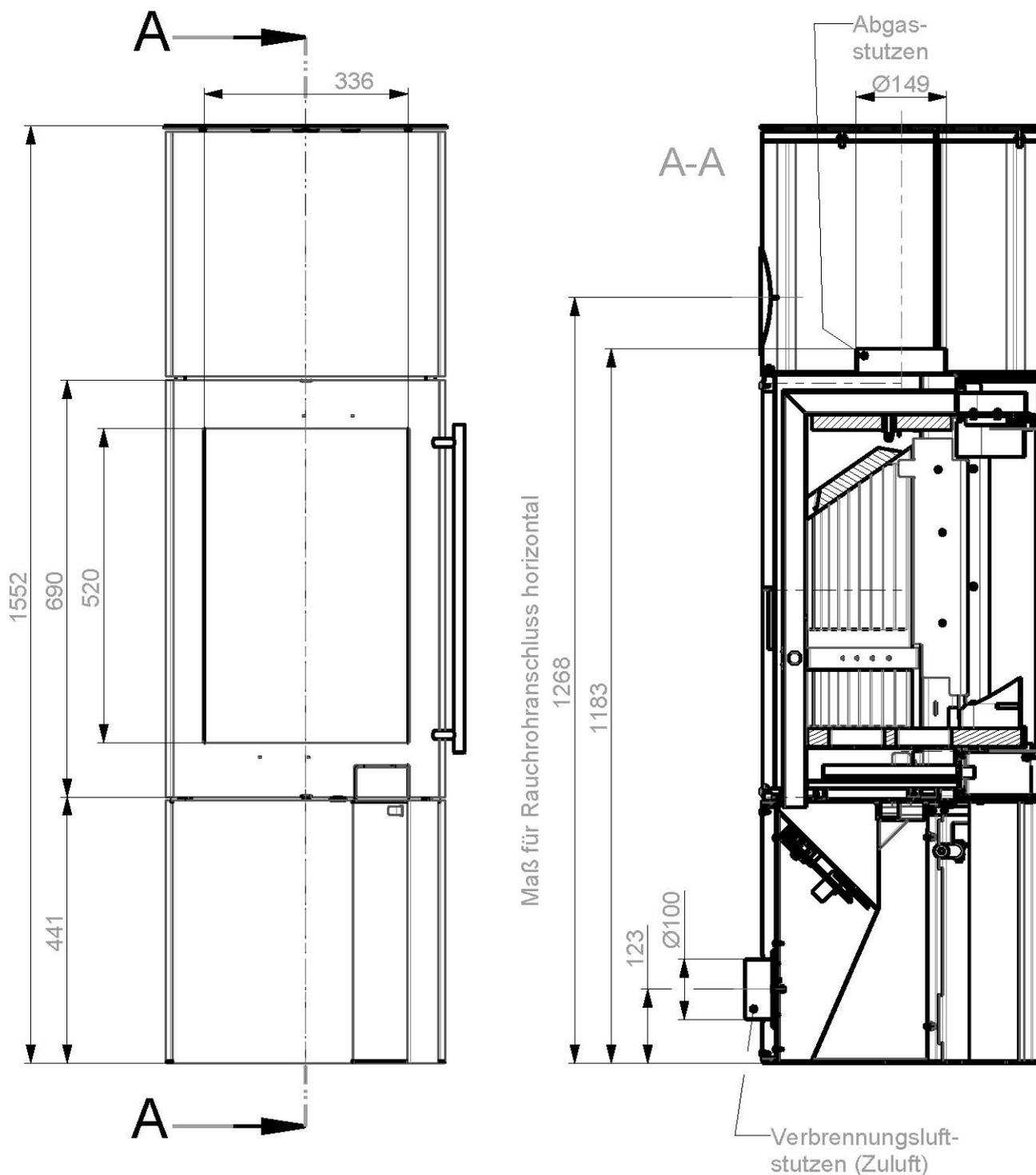
Rauchrohre können am Abgasstutzen wahlweise vertikal oder horizontal angeschlossen werden (siehe Geräteblatt).
