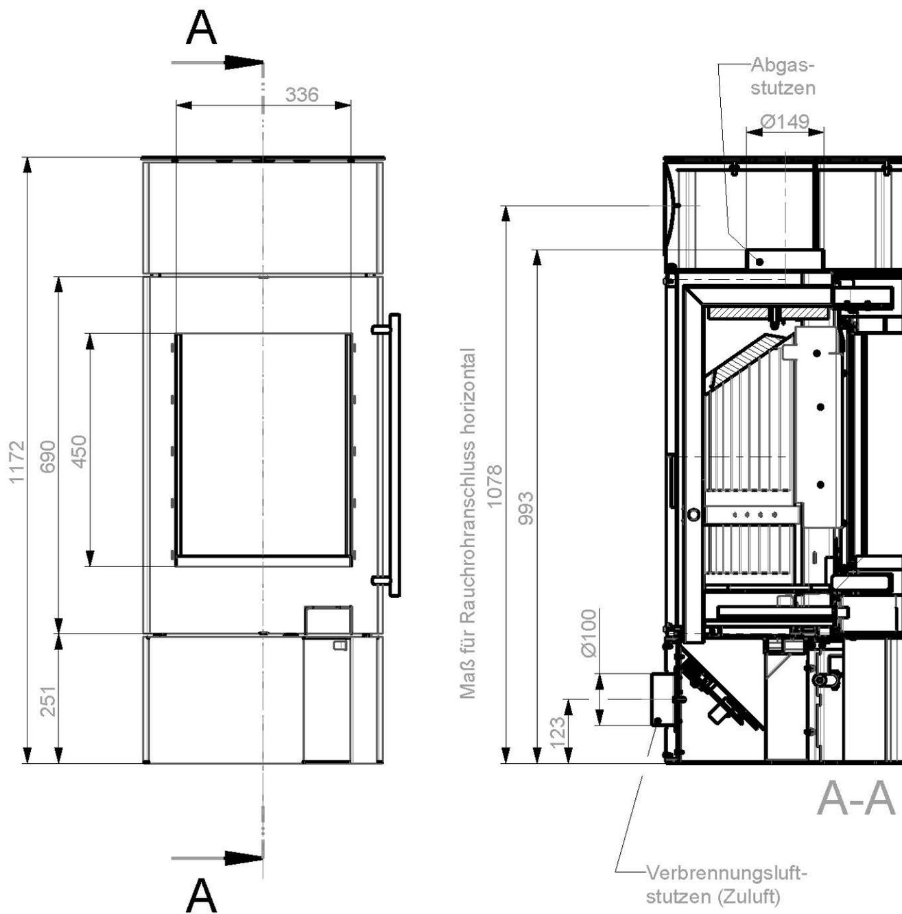
Rauchrohre können am Abgasstutzen wahlweise vertikal oder horizontal angeschlossen werden (siehe Geräteblatt).
