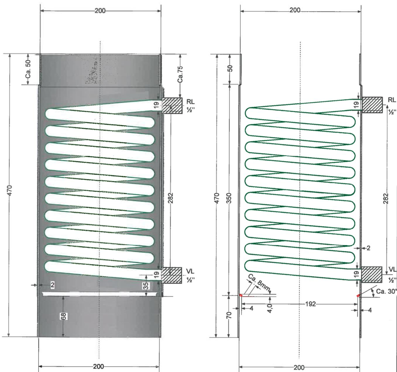
Rauchrohranschlüsse mit Kondensatring ausgeführt
