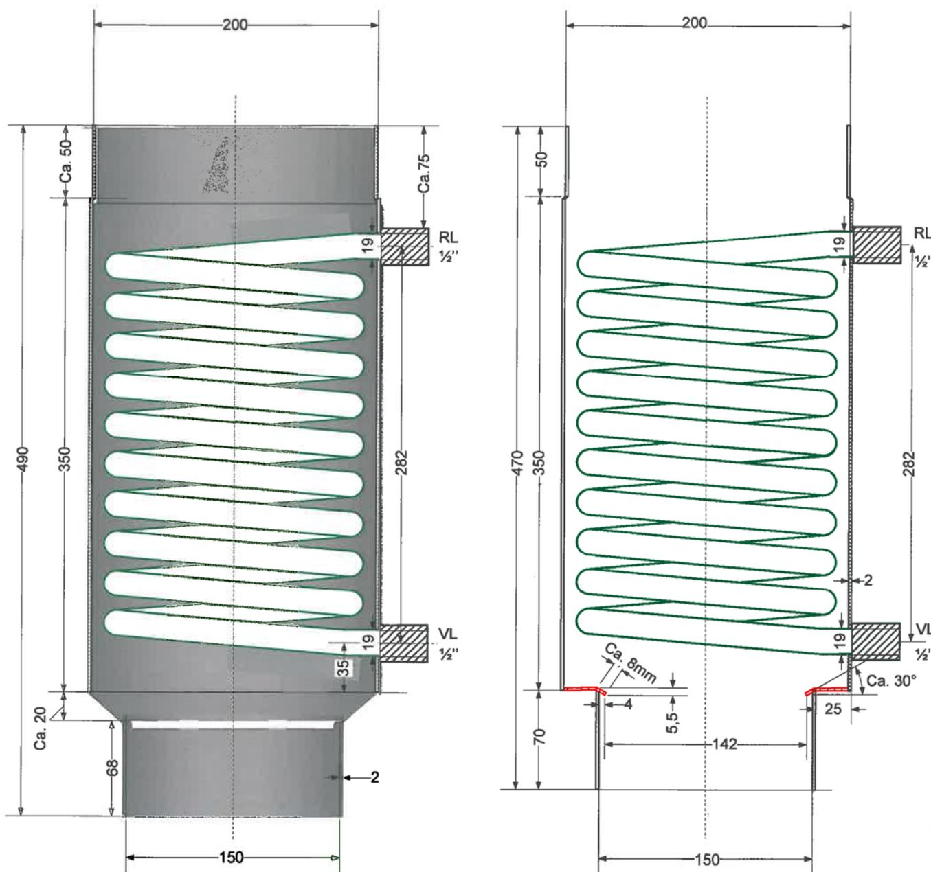
Rauchrohranschlüsse mit Kondensatring ausgeführt
