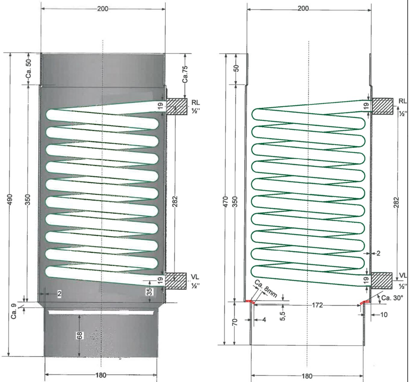
Rauchrohranschlüsse mit Kondensatring ausgeführt
