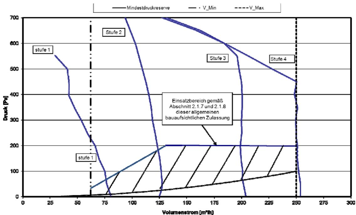
Zentrales Lüftungsgerät mit Wärmerückgewinnung vom Typ "Vitovent 300-W (300 m³/h)"
