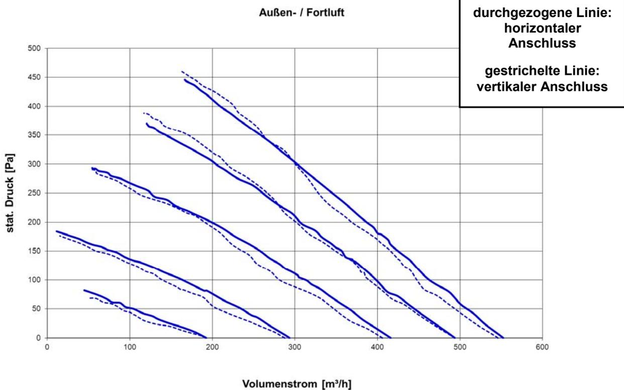
Zentrales Lüftungsgerät mit Wärmerückgewinnung vom Typ "Sentinel Kinetic Plus B" mit horizontalen und vertikalen Anschlüssen
