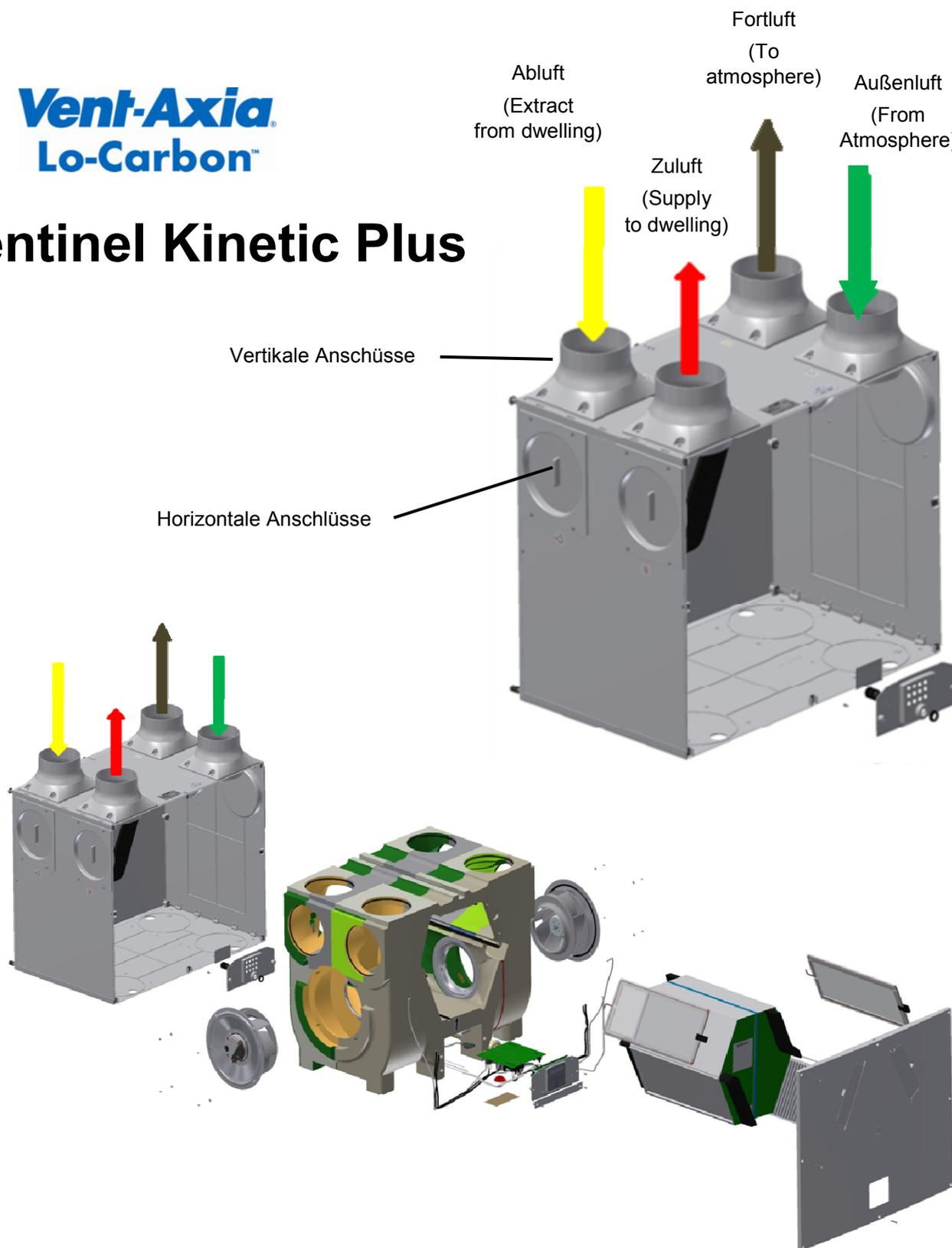
Zentrales Lüftungsgerät mit Wärmerückgewinnung vom Typ "Sentinel Kinetic Plus B" mit horizontalen und vertikalen Anschlüssen
