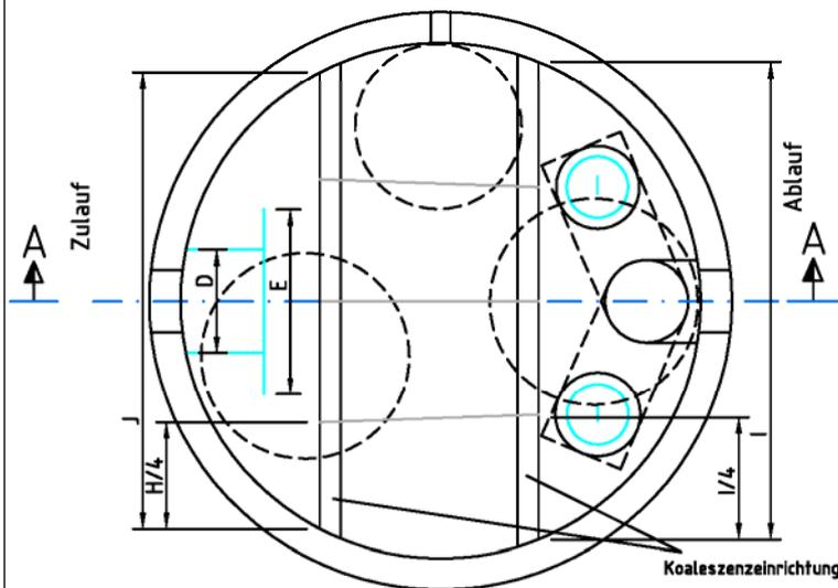
Standarddeckenöffnungen (U) im Behälter φ A 2500 : 2 x φ 1000, 1 x φ 800; alternativ bei Zulauftiefen unter 1,00 m : 3 x φ 625
