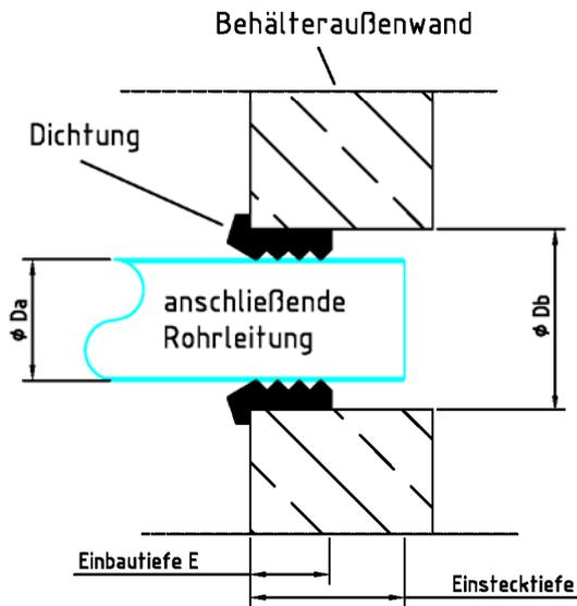
Rohrdurchführungen, Anschluss für Ringraumdichtung.
