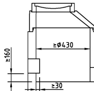
Abscheideranlage aus Beton, bestehend aus Abscheider Klasse I mit Koaleszenzeinrichtung, integriertem Schlammfang und integrierter Probenahmestelle; BENE WK 54.140
