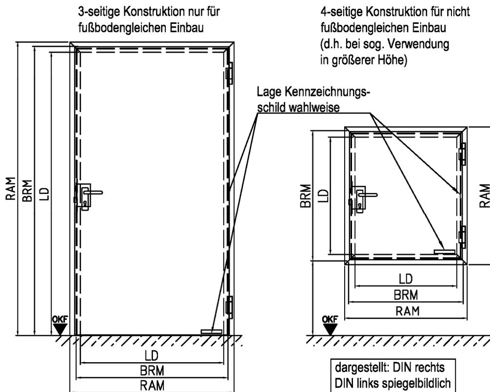
T 90-1-RS-FSA "SCHWARZE-FE" 4-seitige Konstruktion immer mit umlaufender Zargendichtung ausführen und an Wandanschluss versiegeln!
