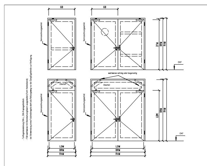
Die T30-1/2-RS Tür immer mit einer Bodendichtung oder 4-seitiger Zarge mit Dichtung ausführen und den Wandanschluss immer versiegeln.
