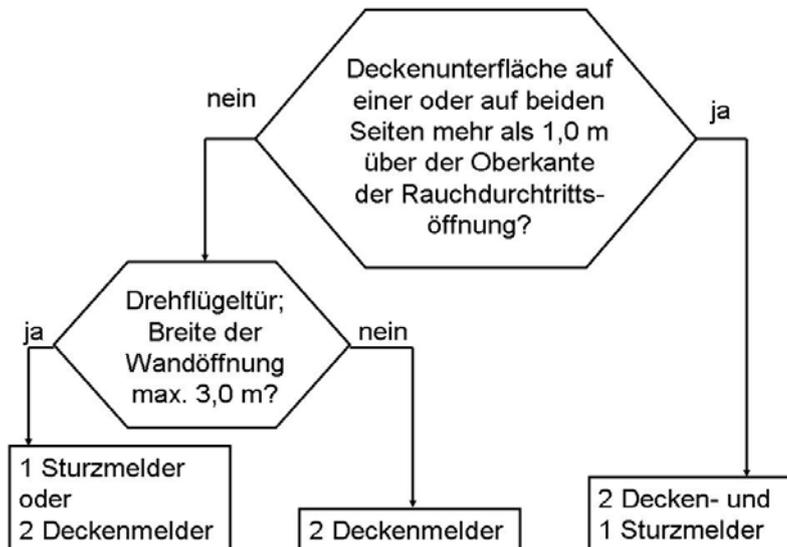
Bild 3: Entscheidungsdiagramm
