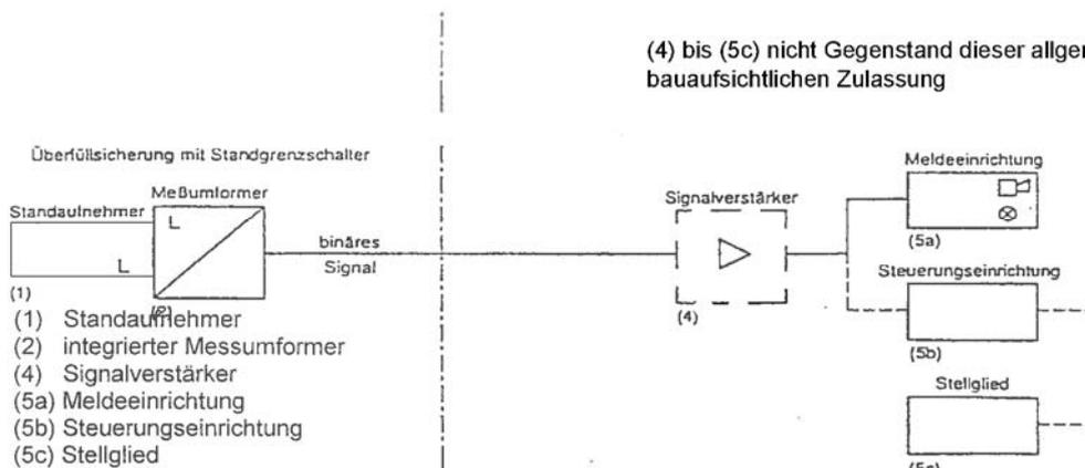
Standaufnehmer (Schwingsonde) mit eingebautem Messumformer Mini-Squing Typ VT... bzw. Rosemount 2110 als Standgrenzschalter von Überfüllsicherungen
