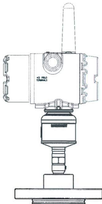
Modell 3051S Wireless, Ausführung Inline mit Druckmittler
