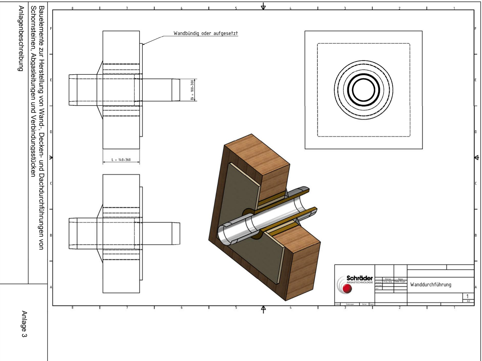
Bauelemente zur Herstellung von Wand-, Decken- und Dachdurchführungen von Schornsteinen, Abgasleitungen und Verbindungsstücken
