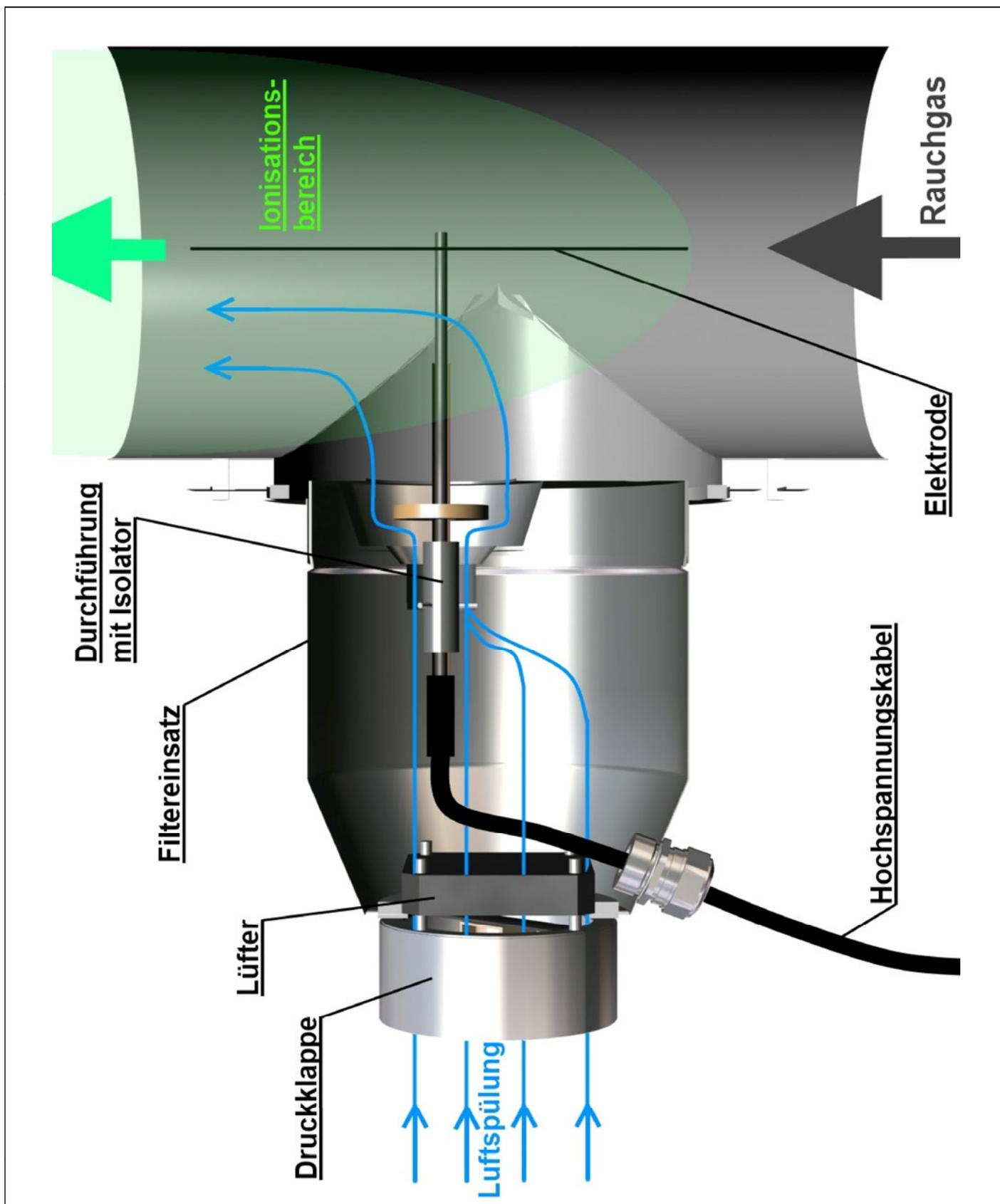
Staubabscheider für Abgasanlagen
