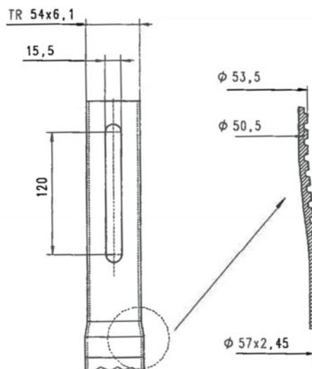
Baustützen aus Stahl mit Ausziehvorrichtung
