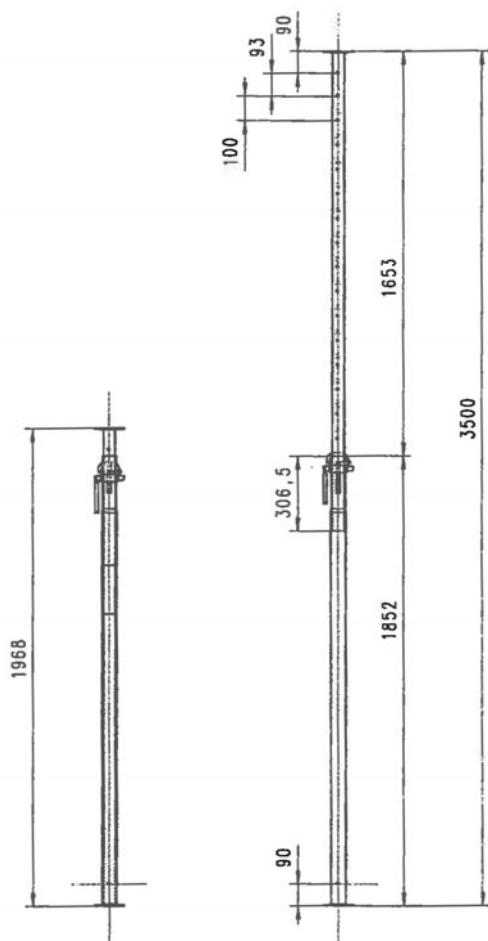
Aussenrohr:  $\phi 60,3 \times 2,45$  S250GD+Z350-M-A-C
