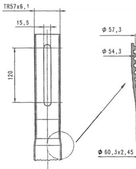
Baustützen aus Stahl mit Ausziehvorrichtung
