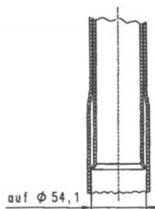
Baustützen aus Stahl mit Ausziehvorrichtung
