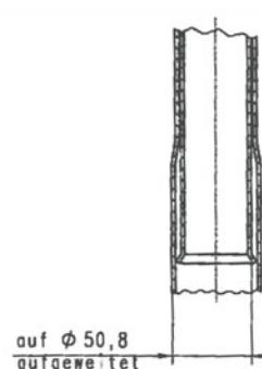
Baustützen aus Stahl mit Ausziehvorrichtung
