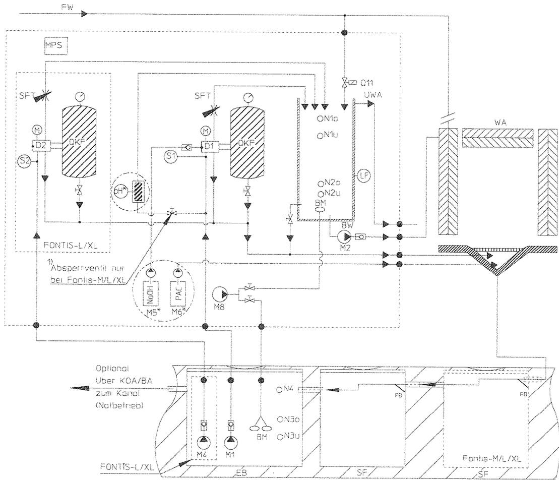
1) Absperrventil ermöglicht während dem Betrieb der Anlage den Austausch PH-Sonde.
