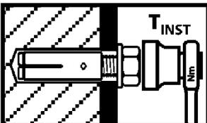
Montagemoment  $T_{inst}$  mit Drehmomentschlüssel aufbringen.
