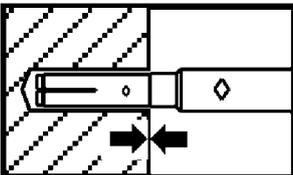
Der Anschlag des Spreizwerkzeugs muss auf dem Ankerrand aufsetzen.
