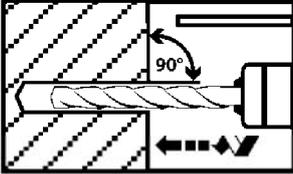
Bohrloch senkrecht zur Oberfläche des Verankerungsgrunds erstellen.
