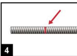
4. Vor dem Injizieren des Mörtels ist die Setztiefe auf dem Bewehrungsstab zu markieren (z.B. mit Klebeband). Danach den Bewehrungsstab in das leere Bohrloch einführen, um die korrekte Bohrlochtiefe  $l_v$  zu überprüfen. Der Bewehrungsstab sollte schmutz-, fett-, und ölfrei sein.
