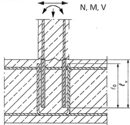
**Bild A3:** Endverankerung von Platten oder Balken
