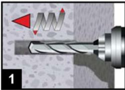
1. Bohrloch mit dem Durchmesser und der Bohrtiefe entsprechend des gewählten Bewehrungs Eisens mit Hammerbohrer (HD) oder Druckluftbohrer (CD) in den Untergrund bohren. Bei Fehlbohrungen ist das Bohrloch zu vermörteln.
