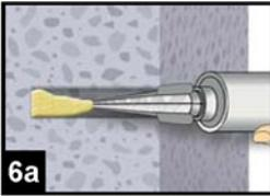
6. Gereinigtes Bohrloch vom Bohrlochgrund her ca. zu 2/3 mit Verbundmörtel befüllen. Langsames Zurückziehen des Statikmischers aus dem Bohrloch verhindert die Bildung von Luftpnehlüssen. Für Setztiefen größer 190 mm passende Mischerverlängerung verwenden.
