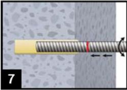
7. Bewehrungsstab mit leichter Drehbewegung (zur Verbesserung der Mörtelverteilung) bis zur Setztiefemarkierung in das Bohrloch einführen
