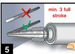
5. Der Mörtelvorlauf ist nicht zur Befestigung des Bewehrungsseisens geeignet. Daher Vorlauf solange verwerfen, bis sich eine gleichmäßig graue Mischfarbe eingestellt hat, jedoch min. 3 volle Hübe.
