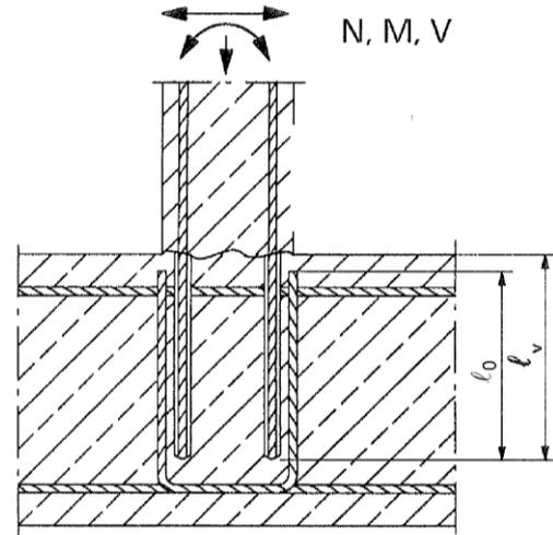
**Bild A3:** Endverankerung von Platten oder Balken
