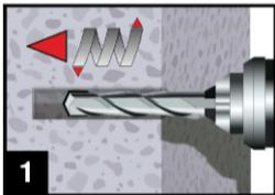
1. Bohrloch mit dem Durchmesser und der Bohrlochtiefe entsprechend des gewählten Bewehrungs Eisens mit Hammerbohrer (HD) oder Druckluftbohrer (CD) in den Untergrund bohren. Bei Fehlbohrungen ist das Bohrloch zu vermörteln.
