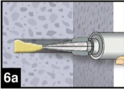
6. Gereinigtes Bohrloch vom Bohrlochgrund her ca. zu 2/3 mit Verbundmörtel befüllen. Langsames Zurückziehen des Statikmischers aus dem Bohrloch verhindert die Bildung von Lufteinschlüssen. Für Setztiefen größer 190 mm passende Mischerverlängerung verwenden.
