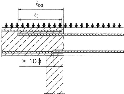
**Bild A2:** Übergreifungsstoß einer biegebeanspruchten Stütze oder Wand an ein Fundament
