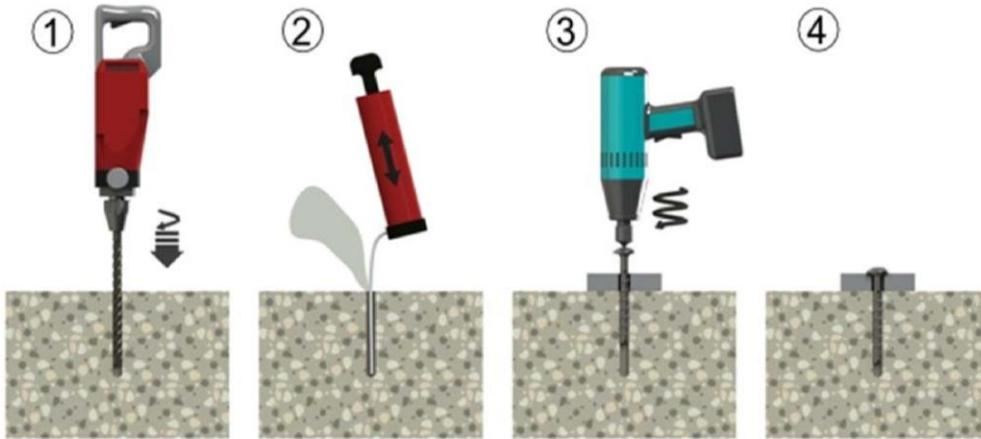
**Montageanleitung in vorgespannten Hohlraumdeckenplatten**
