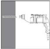
1. Bohrloch dreh Schlagend mit vorgeschriebenem Bohrer Durchmesser (Tabelle B1 oder Tabelle B2) und gewählter Bohrlochtiefe erstellen.
