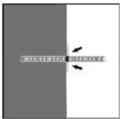
8. Nach der Installation des Ankers sollte der Ringspalt komplett mit Mörtel ausgefüllt sein. Tritt keine Masse nach Erreichen der Verankerungstiefe heraus, ist diese Voraussetzung nicht erfüllt und die Anwendung muss vor Beendigung der Verarbeitungszeit wiederholt werden. Bei Überkopfmontage ist die Ankerstange zu fixieren (z.B. Holzkeile).
