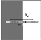
7. Befestigungselement mit leichten Drehbewegungen bis zur festgelegten Setztiefe einführen. Die Ankerstange sollte schmutz-, fett-, und ölfrei sein.
