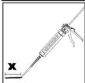
5. Der Mörtelvorlauf ist nicht zur Befestigung der Ankerstange geeignet. Daher Vorlauf solange verwerfen, bis sich eine gleichmäßig graue Mischfarbe eingestellt hat, jedoch min. 3 volle Hübe.
