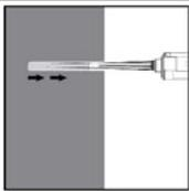
6. Gereinigtes Bohrloch vom Bohrlochgrund her ca. zu 2/3 mit Verbundmörtel befüllen. Langsames Zurückziehen des Statikmischers aus dem Bohrloch verhindert die Bildung von Lufteinschlüssen. Für Verankerungstiefen > 190 mm passende Mischerverlängerung verwenden. Für die Horizontal- oder Überkopfmontage von Ankern > Ø 20 mm sind Verfüllstützen gemäß Anhang B 5 zu verwenden. Die temperaturrelevanten Verarbeitungszeiten (Tabelle B3) sind zu beachten.
