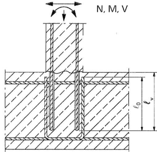
**Bild A3:** Endverankerung von Platten oder Balken
