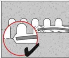
Bohrloch mindestens 2-mal mit der Hilti Ausblaspumpe vom Bohrlochgrund ausblasen bis die rückströmende Luft staubfrei ist.
