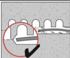
Bohrloch erneut mit der Hilti Handausblaspumpe vom Bohrlochgrund mindestens 2-mal ausblasen bis die rückströmende Luft staubfrei ist.
