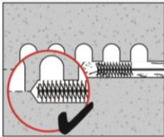
2-mal mit Stahlbürste in passender Größe (siehe Tabelle B5 bis Tabelle B8) bürsten. Stahlbürste Hilti HIT-RB mit einer Drehbewegung in das Bohrloch bis zum Bohrlochgrund einführen und wieder herausziehen. Die Bürste muss beim Einführen einen Widerstand erzeugen (Bürste  $\varnothing \geq$  Bohrloch  $\varnothing$ ) – falls nicht, ist die Bürste zu klein und muss durch eine geeignete Bürste ersetzt werden.
