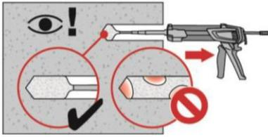
Injizieren des Mörtels vom Bohrlochgrund und während jedes Hubes den Mischer zurückziehen.
