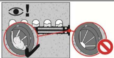
Kontrolle der injizierten Mörtelmenge. Der Mörtel muss aus der Kappe ausgetreten sein.
