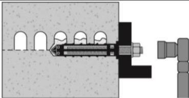
Nach Ablauf der Aushärtezeit  $t_{cure}$  (siehe Tabelle B9 und Tabelle B10) kann der Dübel belastet werden.
