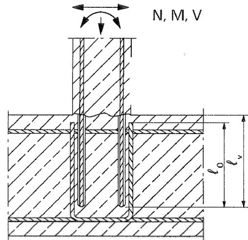
**Bild A3:** Endverankerung von Platten oder Balken
