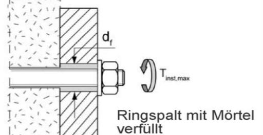
**Innengewindeanker UPM-I ohne Siebhülse UPM SH K; Montage in Vollstein und Porenbeton**
