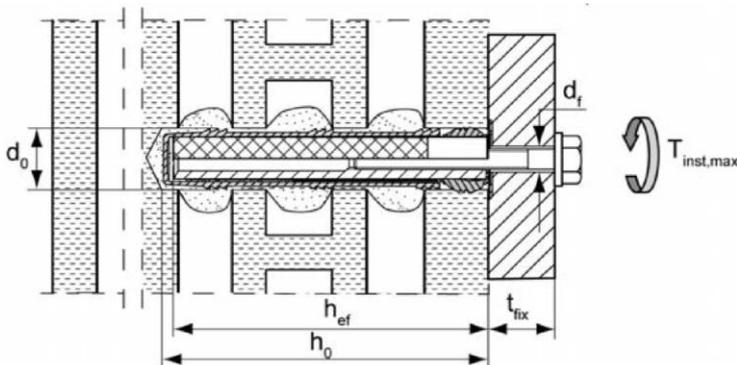
$d_0$  = Bohremendurchmesser
