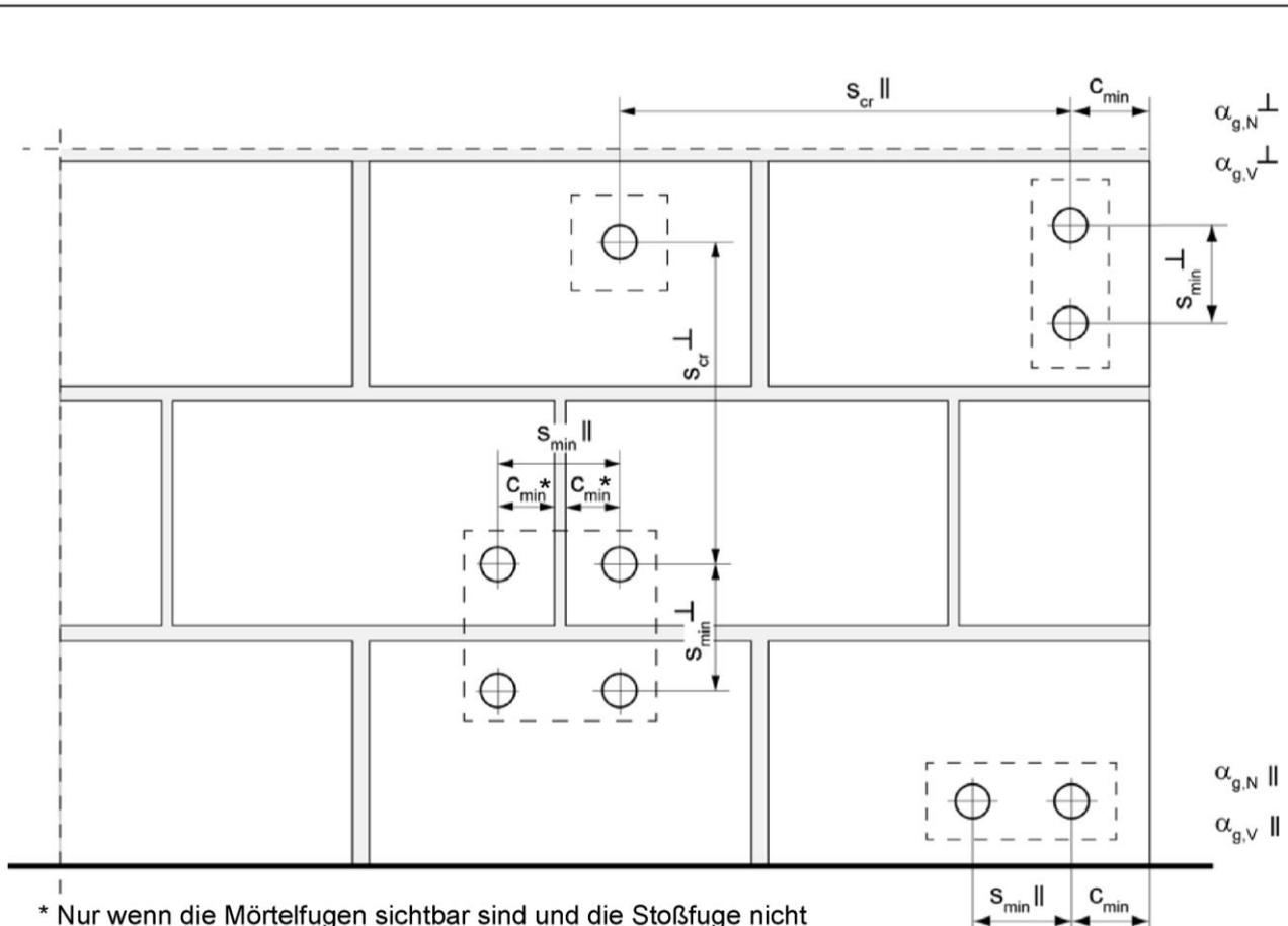
\* Nur wenn die Mörtelfugen sichtbar sind und die Stoßfuge nicht vermörtelt ist
