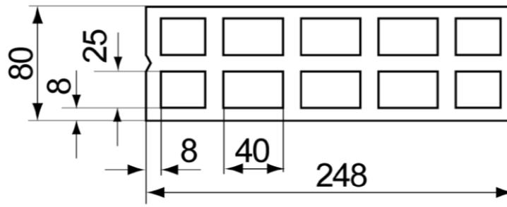
Tabelle C68: Montagekennwerte für Ankerstangen mit Siebhülse
