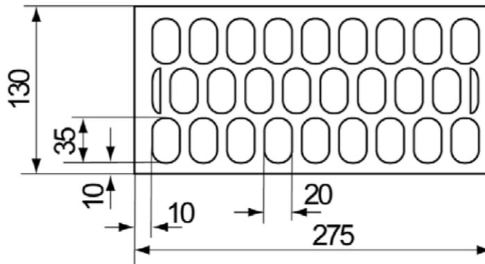
Tabelle C72: Montagekennwerte für Ankerstangen mit Siebhülse
