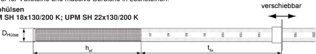
Upat Injektionssystem UPM 44 für Mauerwerk
