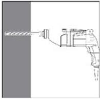
1. Bohrloch mit dem Durchmesser und der Bohrlochtiefe entsprechend des gewählten Bewehrungs Eisens mit Hammerbohrer (HD) oder Druckluftbohrer (CD) in den Untergrund bohren.
