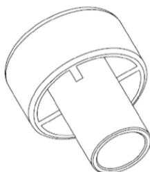
**Injektionsadapter für Überkopf- oder Horizontalmontage**
