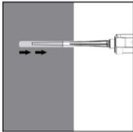
6. Gereinigtes Bohrloch vom Bohrlochgrund her ca. zu 2/3 mit Verbundmörtel befüllen. Langsames Zurückziehen des Statikmischers aus dem Bohrloch verhindert die Bildung von Luftpneumaten. Für Setztiefen größer 190 mm passende Mischerverlängerung verwenden.
