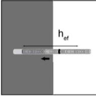
7. Bewehrungsstab mit leichter Drehbewegung (zur Verbesserung der Mörtelverteilung) bis zur Setztiefemarkierung in das Bohrloch einführen
