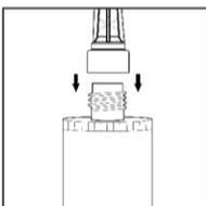
3. Den mitgelieferten Statikmischer fest auf die Kartusche aufschrauben und Kartusche in eine geeignete Auspresspistole einlegen.
