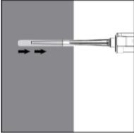
6. Gereinigtes Bohrloch vom Bohrlochgrund her ca. zu 2/3 mit Verbundmörtel befüllen. Langsames Zurückziehen des Statikmischers aus dem Bohrloch verhindert die Bildung von Luftschlüssen. Für Setztiefen größer 190 mm passende Mischerverlängerung verwenden.
