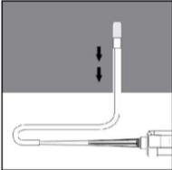
Für die Horizontal- oder Überkopfmontage sowie bei Bohrlöchern tiefer als 240mm sind Verfüllstützen zu verwenden.
