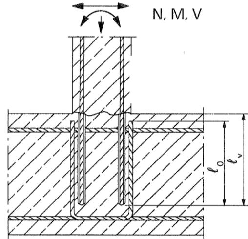
**Bild A3:** Endverankerung von Platten oder Balken
