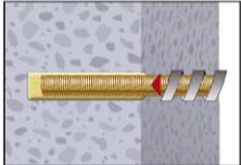
7. Befestigungselement mit leichten Drehbewegungen bis zur festgelegten Setztiefe einführen.
