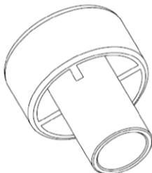
**Verfüllstutzen für Überkopf- oder Horizontalmontage**
