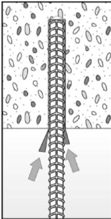
Bei Überkopfmontage den Betonstahl gegen Herausfallen mit Keilen sichern bis der Mörtel auszuhärten beginnt.
