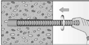
Den Betonstahl mit hin und her drehenden Bewegungen in das verfüllte Bohrloch bis zur Setztiefenmarkierung einführen.
