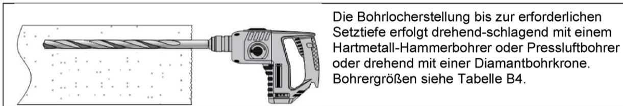
Die Bohrlocherstellung bis zur erforderlichen Setztiefe erfolgt drehend-schlagend mit einem Hartmetall-Hammerbohrer oder Pressluftbohrer oder drehend mit einer Diamantbohrkrone. Bohrergrößen siehe Tabelle B4.
