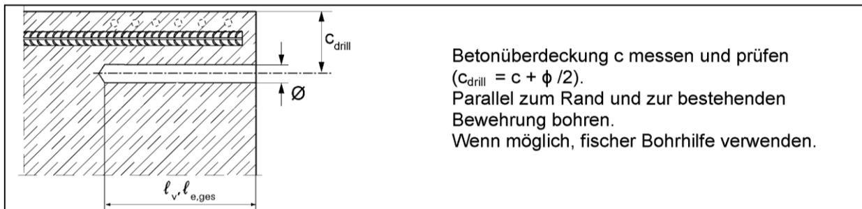
Betonüberdeckung  $c$  messen und prüfen ( $C_{drill} = c + \phi / 2$ ).
