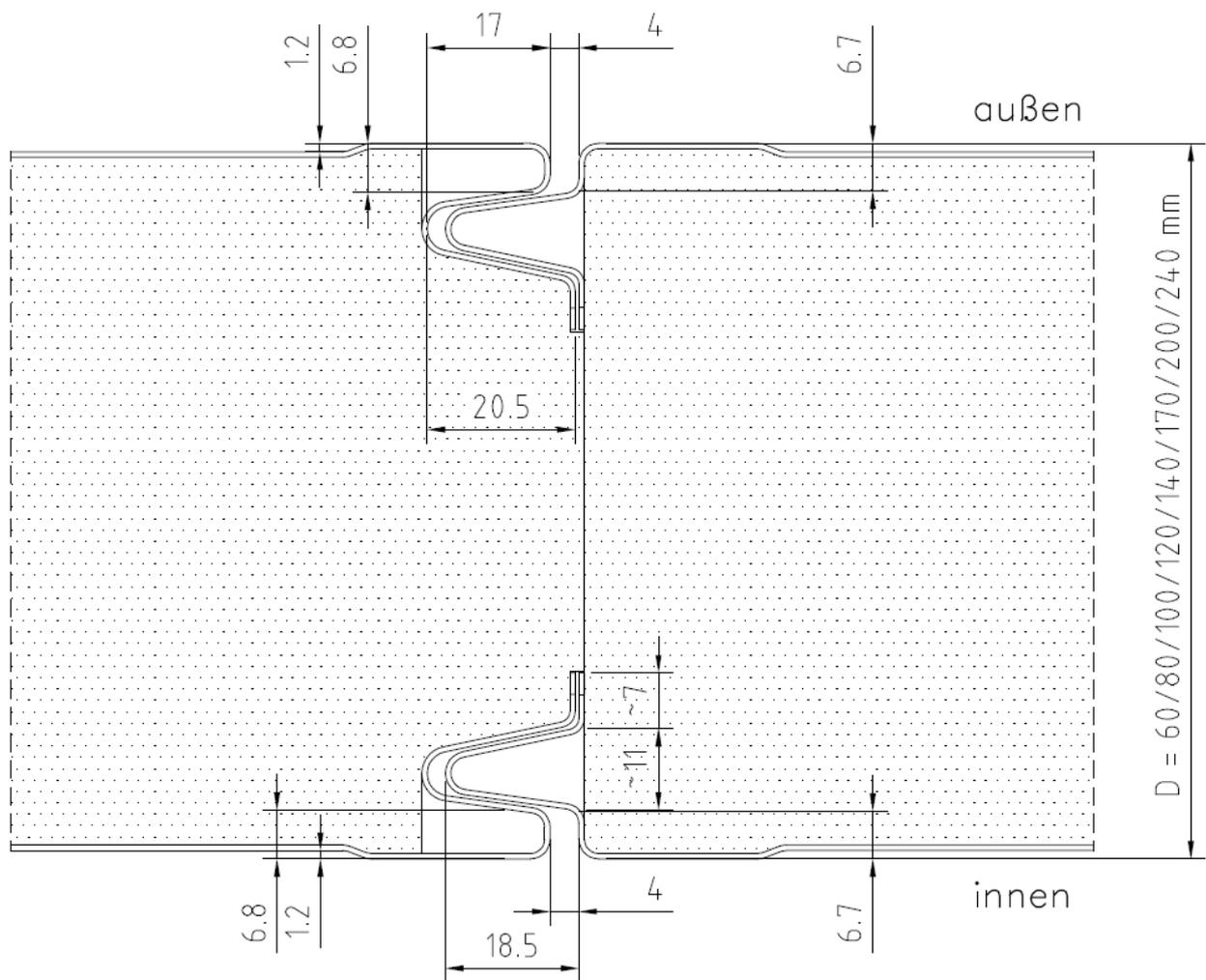
Sandwichelemente "ROMA Schnellbau Dämmpaneele" nach EN 14509 mit
