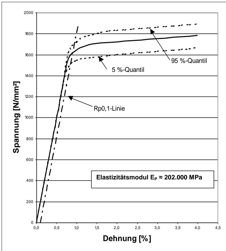
Die gestrichelten Linien markieren den Bereich, innerhalb dessen die tatsächlichen Spannungs-Dehnungslinien auftreten können.
