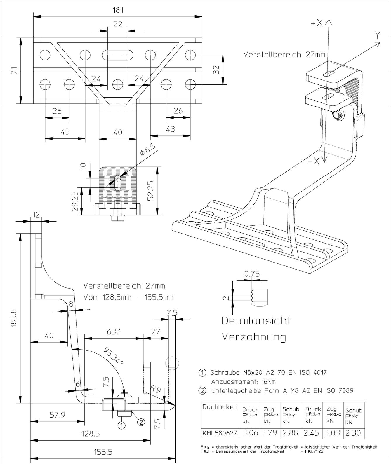
Dachhaken KML zur mechanischen Befestigung von Solarmodulen
